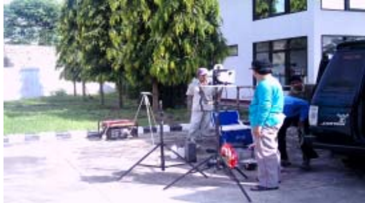
Gambar 4.1. Pemantauan udara ambient di areal SPBU
